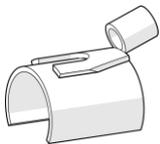
Abb. 20: Einspeiseschuh mit Quetschverbindung
