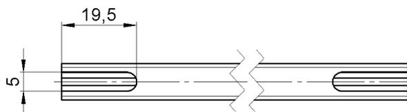
Abb. 26: Schlitz bis zur Bohrung einschneiden
