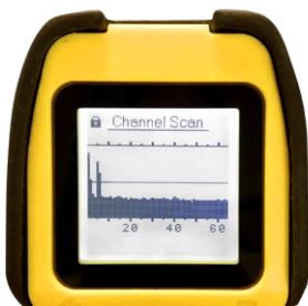
Anzeige der Funksignalstärke um die Funkverhältnisse in der Betriebszone erfassen zu können
