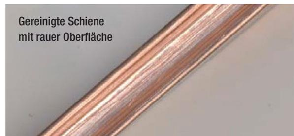
Abb.: geschädigte Schiene nach Bürsteneinsatz
