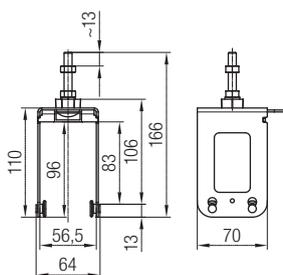
Für Anwendungen mit größeren Temperaturschwankungen oder exponierter Lage (Risiko der Havarie oder kritischen Umgebungsbedingungen wie z.B. hohe Luftbelastung mit Bohremulsion, Lösemittel Aromaten etc. ) werden Schienerhalter mit Rollenaufnahme empfohlen.
