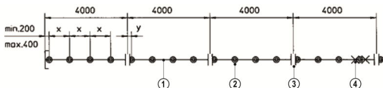
Abb. 7: Verteilung von Schienenhalter, Schienenverbinder und Fixpunkten
