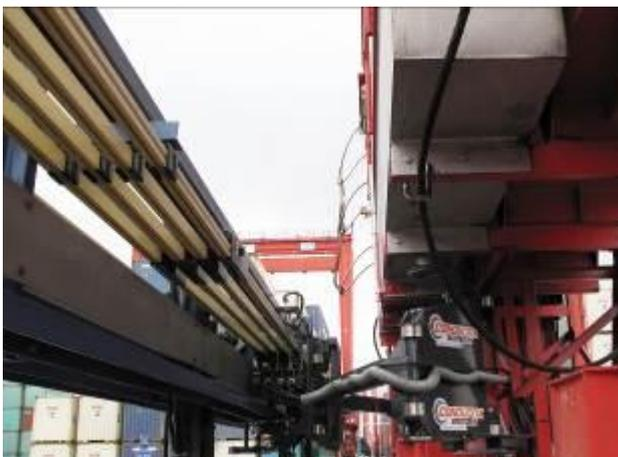
*BU: Seit 2009 fahren mit „Drive-In“ ausgerüstete E-RTGs durch 32 Containergassen des chinesischen Shekou Container Terminal in China.*
