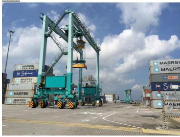
BU: Dank der von Conductix-Wampfler entwickelten Systemlösung Full E-RTG mit modernster Ladetechnologie benötigen E-RTGs zukünftig auch für Block- und Gassenwechsel oder Fahrten in den Wartungsbereich keinen Diesel mehr.
