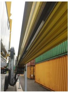
BU: Lösung für E-RTGs: Integrierte Energie- und Datenübertragung ProfiDAT® mit PE
