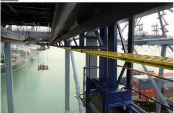
BU: ProfiDAT® Datenübertragung von Conductix-Wampfler wird als Profil parallel zu den bestehenden Schleifleitungen an STS-Containerkranen ergänzt, oder auch als integrierte Lösung mit dem PE installiert. Die ProfiDAT® Antenne bewegt sich innerhalb des Profils und ist über eine Ethernet-Schnittstelle im Kontakt mit dem Transceiver.
